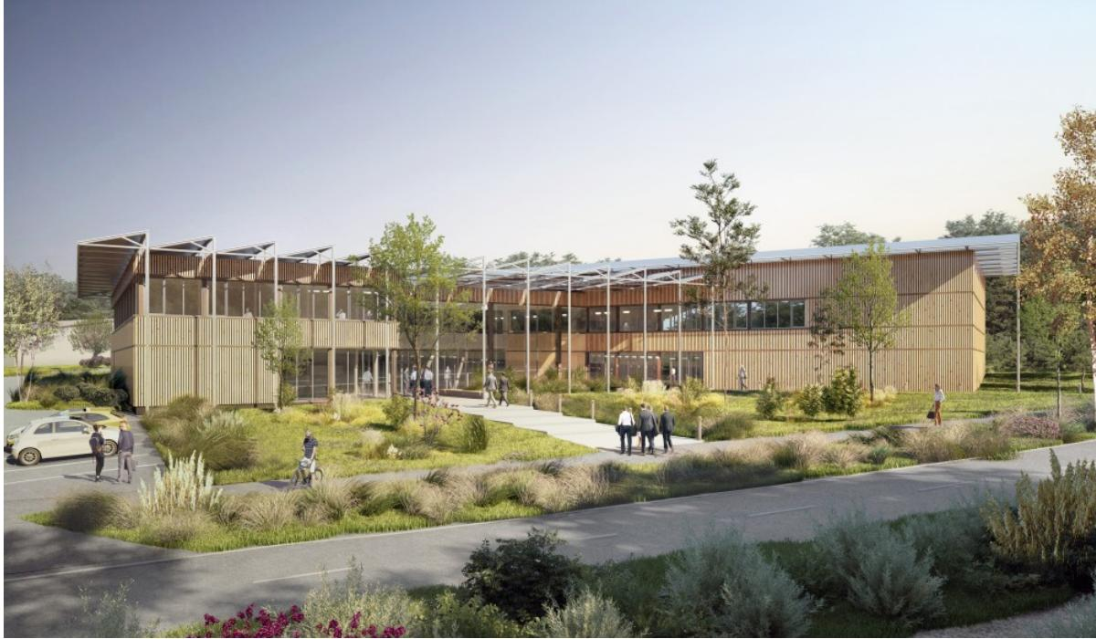
Ce projet propose un parti architectural et technique ambitieux qui allie haute technologie et haute qualité environnementale. Plus qu'un bâtiment, c'est un manifeste basé sur un concept simple : la construction d'un bâtiment en matériaux biosourcés (bois et paille) sous une nappe de panneaux photovoltaïques, la canopée.
